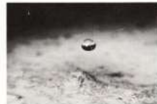
Figura 2 Impacto de una gota de lluvia sobre suelo desnudo
